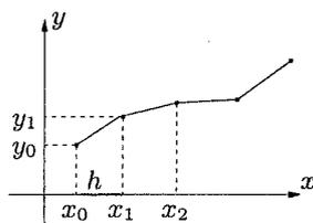
Es handelt sich dabei um ein **Verfahren erster Ordnung**, d.h. der Fehler wächst mit der Schrittweite, i.e.  $|y_n - y(x_n)| \leq \text{const} \cdot h$ .
