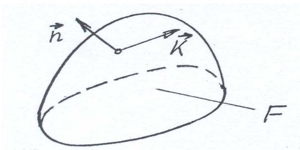
$\Phi(F)$  sei der Fluß durch  $F$  ("Anzahl der Feldlinien" durch die Fläche). Als Maß für den Fluß wählen wir die Projektion von  $\vec{K}$  parallel zu  $\vec{n}$  mal Flächenelement  $do$ , summiert über die gesamte Fläche.
