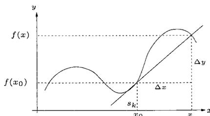
Die Steigung  $k_s$  der Sekante ist  $k_s = \frac{y-y_0}{x-x_0} = \frac{\Delta y}{\Delta x} = \frac{f(x)-f(x_0)}{x-x_0}$ .
