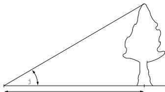
Man berechne die Höhe des Baumes und den absoluten und den relativen Fehler des berechneten Wertes, wenn der Winkel  $\varphi$  mit  $30^\circ$  und einem möglichen Fehler von  $1^\circ$  gemessen wird.
