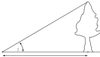
Man berechne die Höhe des Baumes und den absoluten und den relativen Fehler des berechneten Wertes, wenn der Winkel  $\varphi$  mit  $30^\circ$  und einem möglichen Fehler von  $1^\circ$  gemessen wird.
