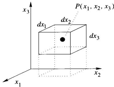
In  $x_1$ -Richtung liegt die "Eintrittsfläche"  $dx_2 dx_3$  (mit Normalenvektor  $\vec{e}_1$ ) bei  $x_1 - \frac{dx_1}{2}$ , die "Austrittsfläche" bei  $x_1 + \frac{dx_1}{2}$ .
