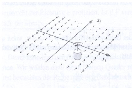
Hier wächst der Impuls der strömenden Flüssigkeit mit wachsenden Werten von  $x_1$ . Die Rotation ist überall konstant und weist in  $x_3$ -Richtung.
