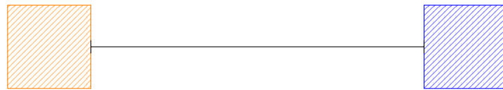
Abbildung 3.4.8: Auf der linken Seite des Stabs sitzt ein Isolator, auf der rechten Seite ein „Eisblock“.
